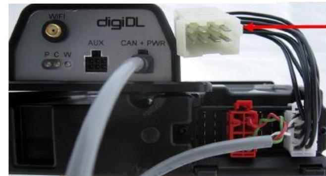
Nouveau connecteur CAN Bus A à connecter avec le connecteur A du véhicule
